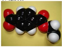
PETは主鎖に炭素以外の原子が入っているので,エンジニアリングプラスチックに分類されます。 主鎖に炭素以外の原子が入ると化学構造が複雑になり,高価になりますが,耐熱性が良くなるなど,性能も上がります。
