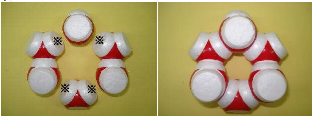
写真の※印の面に木工ボンドを多めに付け、あまり乾かないうちに部品をつけます。少し乾いてから面と面がぴったりつくように少しずつ動かします。
